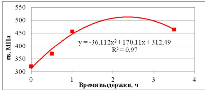
Рис.7. Изменение прочности в сплаве Д16 при  $T=200^{\circ}C$
