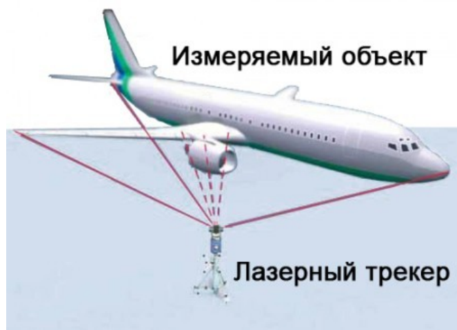
Рис. 2. Контроль геометрии крупногабаритных сборок
