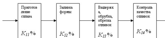
Рис. 2. Часть производственного процесса изготовления отливки
