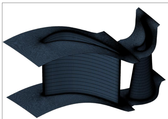
Рис. 7. Внешний вид сетки конечных элементов в расчетной модели первой ступени турбины, созданной в программе NUMECA
