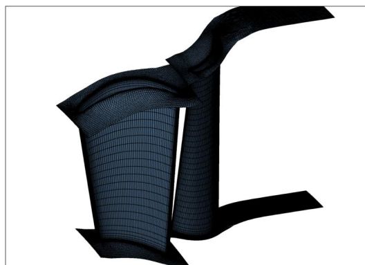
Рис. 8. Внешний вид сетки конечных элементов в расчетной модели второй ступени турбины, созданной в программе NUMECA.
