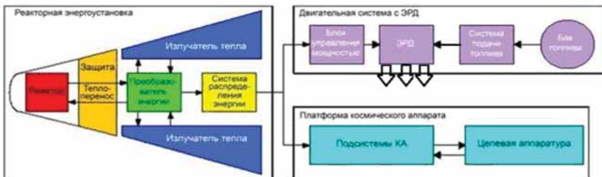
Рис. 1. Блок-схема ЯЭРДУ с ЭРД
