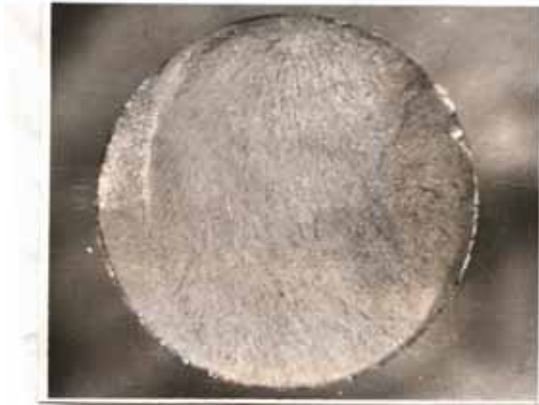
Рис. 4. Усталостный излом упрочненного образца из сплава VT9
