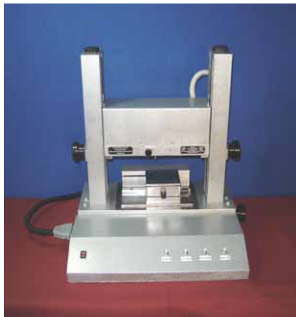
Рис. 4. Диагностический программно-аппаратурный комплекс для оценки качества поверхностей
