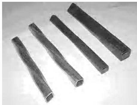
Рис. 5. Образцы профильных винтообразно закрученных труб
