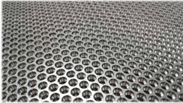
Рис. 4. Общий вид отверстий эмиссионного электрода
