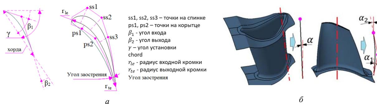
Рис. 4. Схемы параметризации лопаток турбины: а – сечения лопаток; б – выносы сечений по высоте
