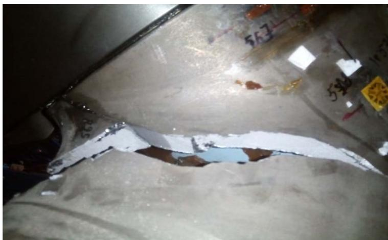
*Рис. 2. Место зарождения и роста усталостной трещины в траверсе*
