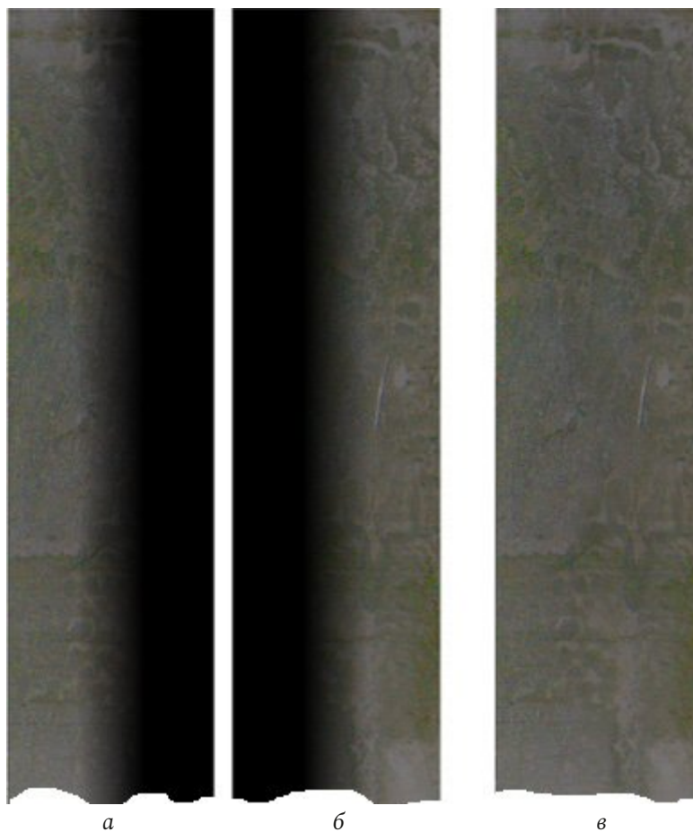
Рис. 9. Сшивка кадров способом наложения перекрывающихся областей: а – следующий кадр с линейным градиентом в области перекрытия; б – текущий кадр с линейным градиентом в области перекрытия; в – результат совмещения двух кадров Fig. 9. Stitching frames by overlapping overlapping areas: a – next frame with a linear gradient in the overlap area; b – current frame with a linear gradient in the overlap area; c – the result of combining two frames
