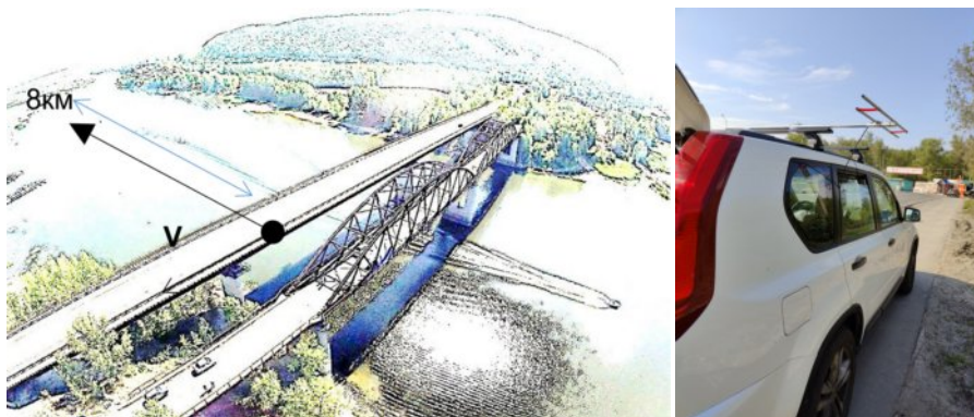
Рис. 4. Геометрия наземного эксперимента и размещение антенны PCA на автомобиле Fig. 4. Geometry of the ground experiment and placement of the SAR antenna on the vehicle
