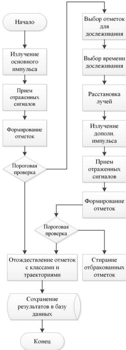
Рис. 2. Алгоритм управления АР, совмещающий жесткую программу смешанного обзора с гибкой программой обзора для отобранных целей
