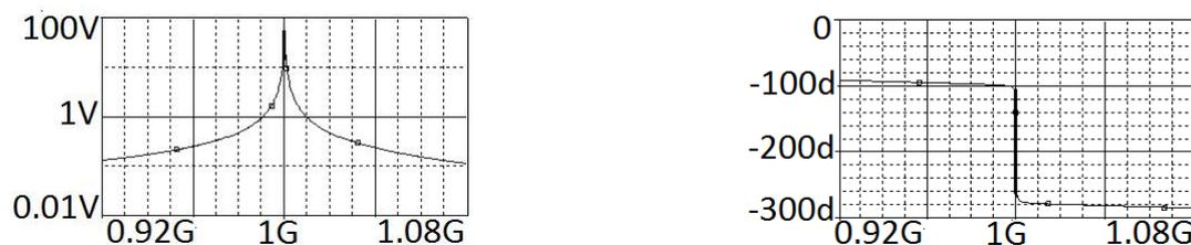
Рис. 12. АЧХ (а) и ФЧХ (б) эквивалентной схемы усилителя (рис. 11), полученные в системе OrCad (б)
