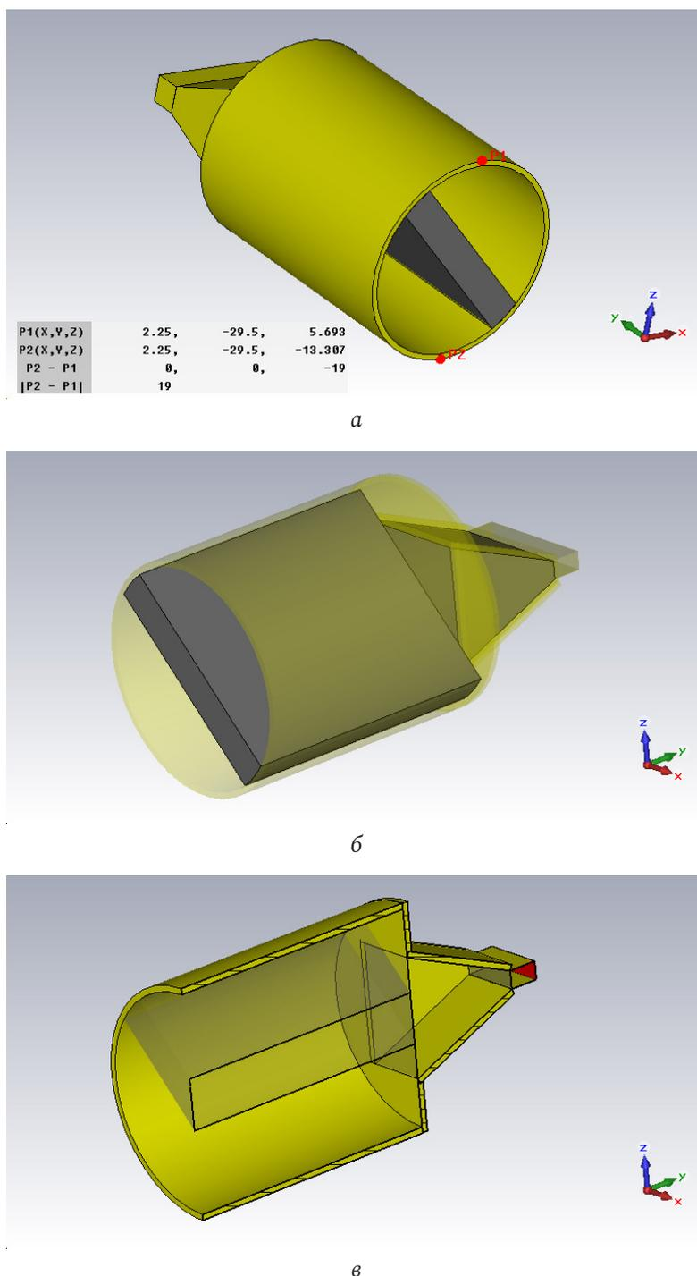
Рис. 1. Конструкция антенны, включающей линейный переход в E-плоскости и фазосдвигающую секцию в круглом волноводе
