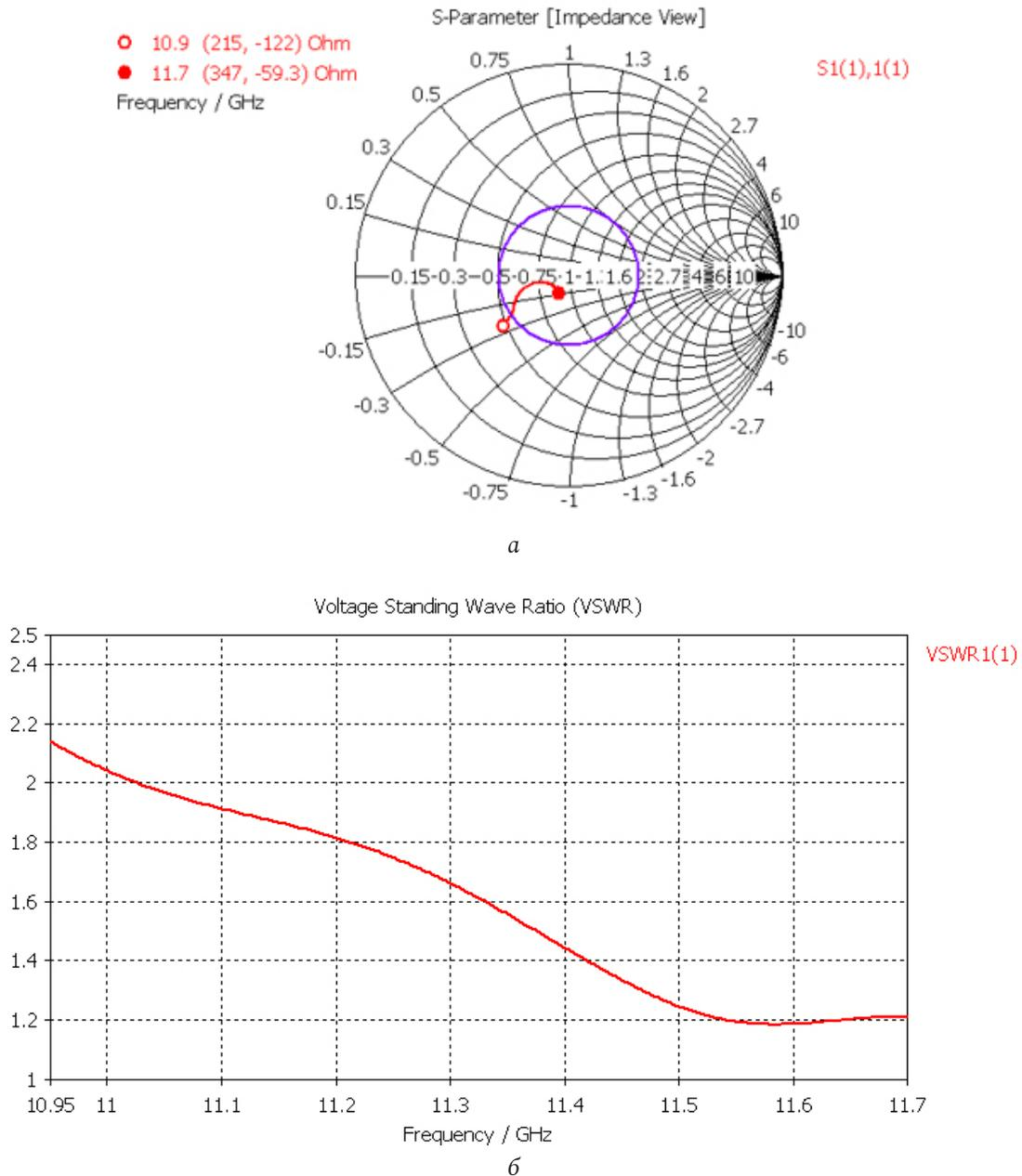
Рис. 2. Входные характеристики антенного элемента (рис. 1)
