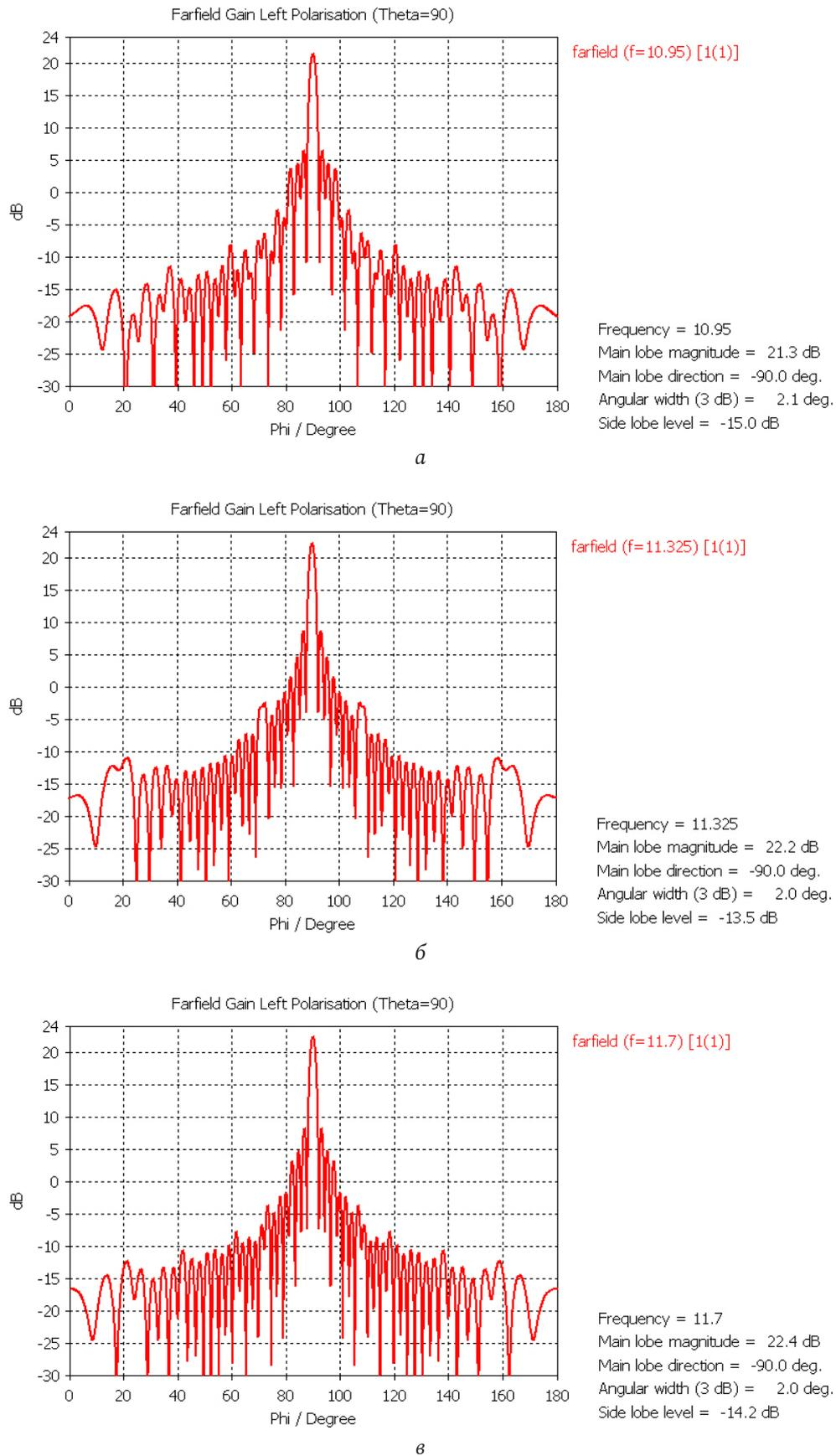
Рис. 6. Диаграммы направленности в азимутальной плоскости синфазной и равноамплитудной линейной антенной решетки из 32 волноводных элементов с фазирующими секциями, расположенных с периодом 21 мм
