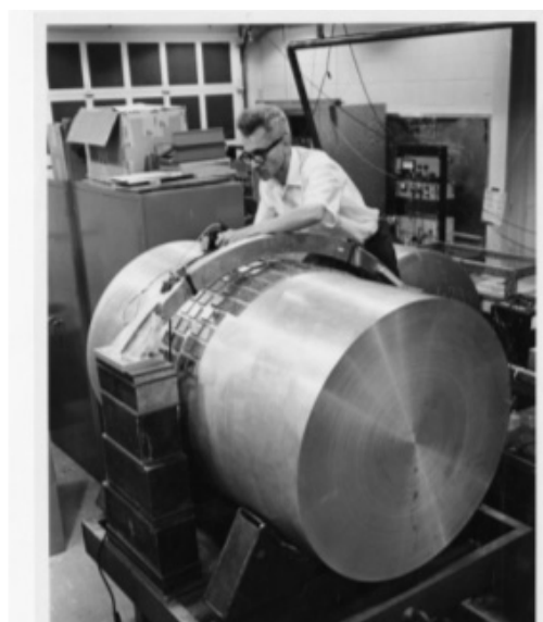
Рис. 2. Схема детектора ГВ механического типа, известного как «Вебер бар», и фотография Дж. Вебера с разработанным им первым детектором в 1960-е Fig. 2. Scheme of GW detector «Weber bar». Photoshoot of J. Weber and the detector he designed in 60's
