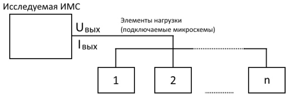
Рис. 2. Схема подключения нагрузок к исследуемой микросхеме Fig. 2. Scheme of connecting loads to the investigated microcircuit
