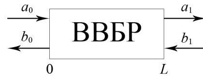
Рис. 1. ВВБР как четырехполюсник Fig. 1. Chiral fiber Bragg grating as a quadripole
