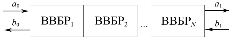
Рис. 6. Матричная модель нерегулярной ВВБР Fig. 6. Matrix model of irregular chiral fiber Bragg grating
