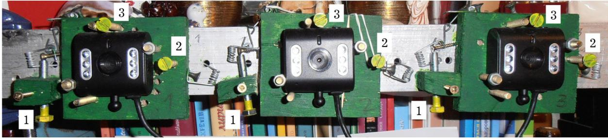
Рис. 1. Фотография стенда (цифрами отмечены регулировочные винты)
