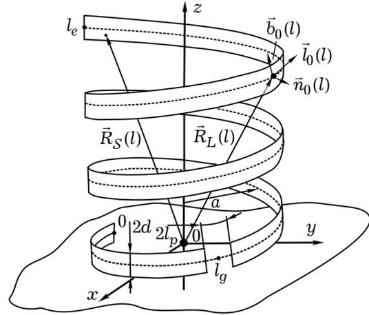
Рис. 1. Геометрия спиральной антенны
