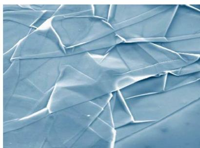
Рис. 2. Слои графена на кремниевой подложке (изображение с электронного микроскопа с увеличением 5000 раз) [4]
