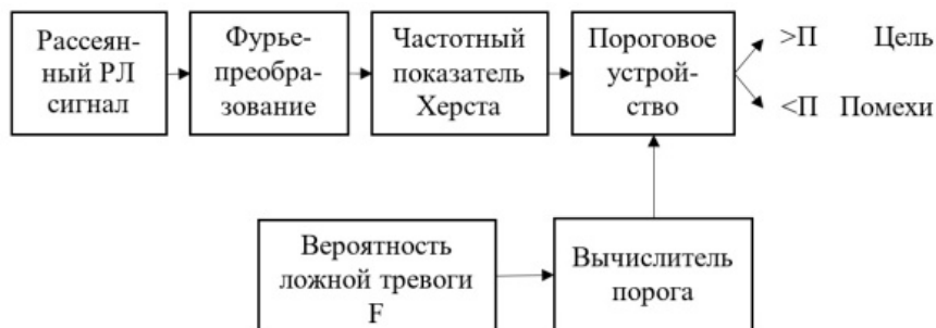
Рис. 6. Фрактальный обнаружитель на основе показателя Херста
