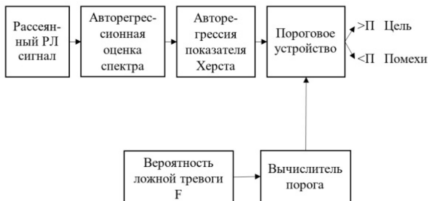
Рис. 7. Фрактальный обнаружитель с авторегрессионной оценкой спектра помехи и показателя Херста
