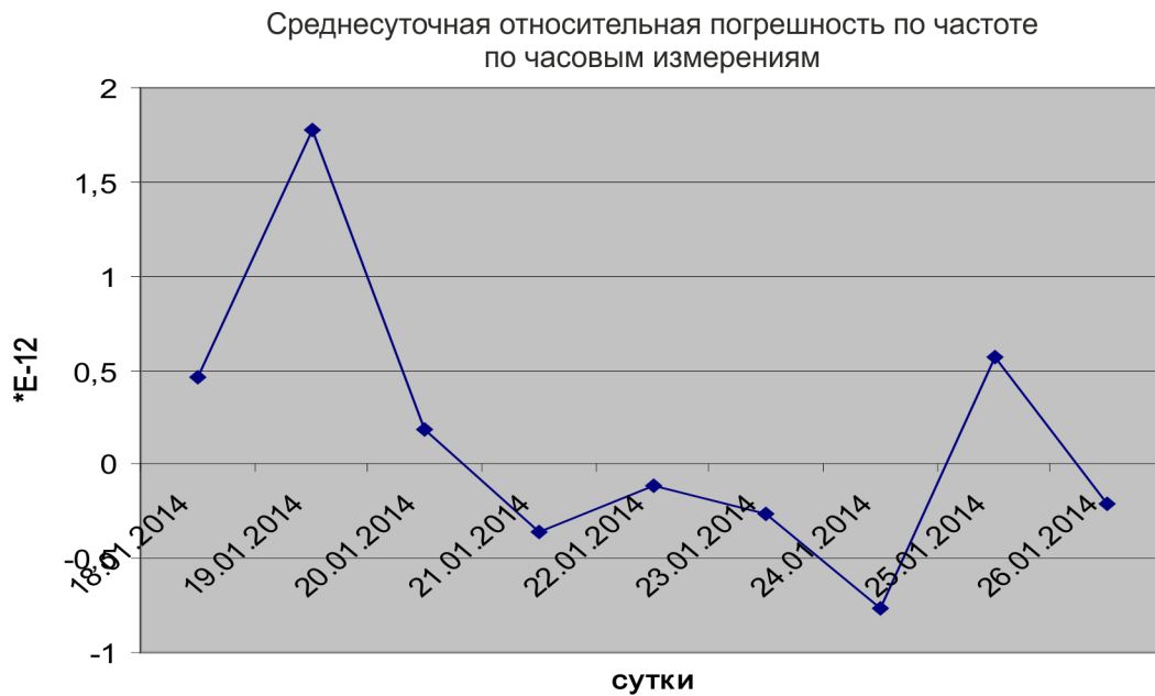
Рис. 4. График среднесуточной погрешности измерений приемника-компаратора ЧК7-56
