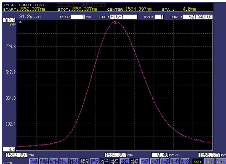
Рис. 9. Спектр отражения одной решетки
