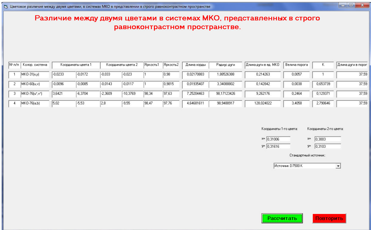
Рис. 5. Вычисление цветовых различий между двумя цветами в строго равноконтрастном цветовом пространстве
