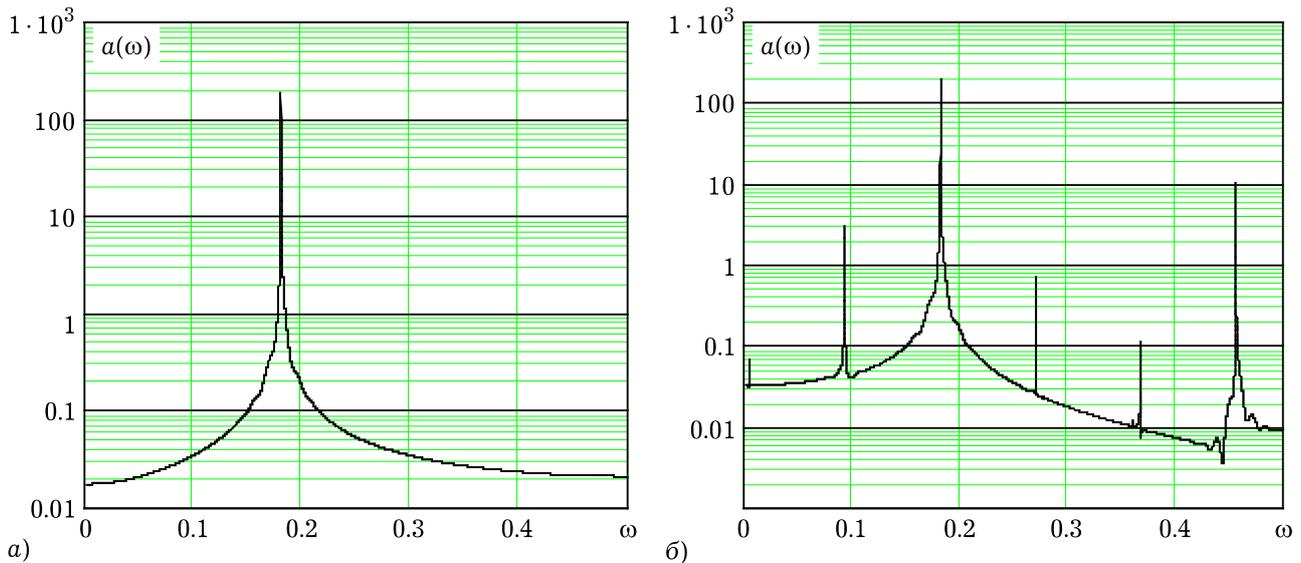
Рис. 1. Амплитудные спектры автоколебаний в ДВ-генераторах (8) и (9)
