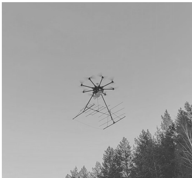
Рис. 1. Внешний вид прототипа-демонстратора РСА УКВ-диапазона для БПЛА в процессе летных испытаний Fig. 1. Appearance of the prototype demonstrator of the VHF range SAR for UAVs during flight testing
