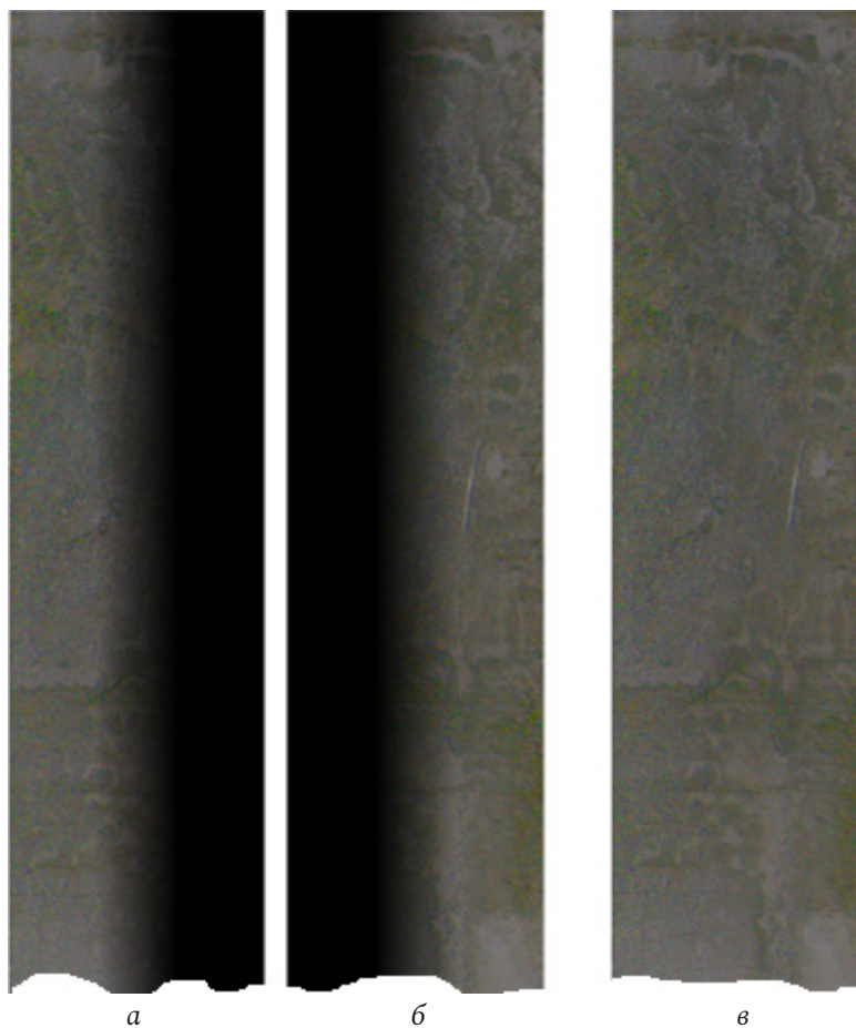
Рис. 9. Сшивка кадров способом наложения перекрывающихся областей: a – следующий кадр с линейным градиентом в области перекрытия; б – текущий кадр с линейным градиентом в области перекрытия; в – результат совмещения двух кадров Fig. 9. Stitching frames by overlapping overlapping areas: a – next frame with a linear gradient in the overlap area; b – current frame with a linear gradient in the overlap area; c – the result of combining two frames
