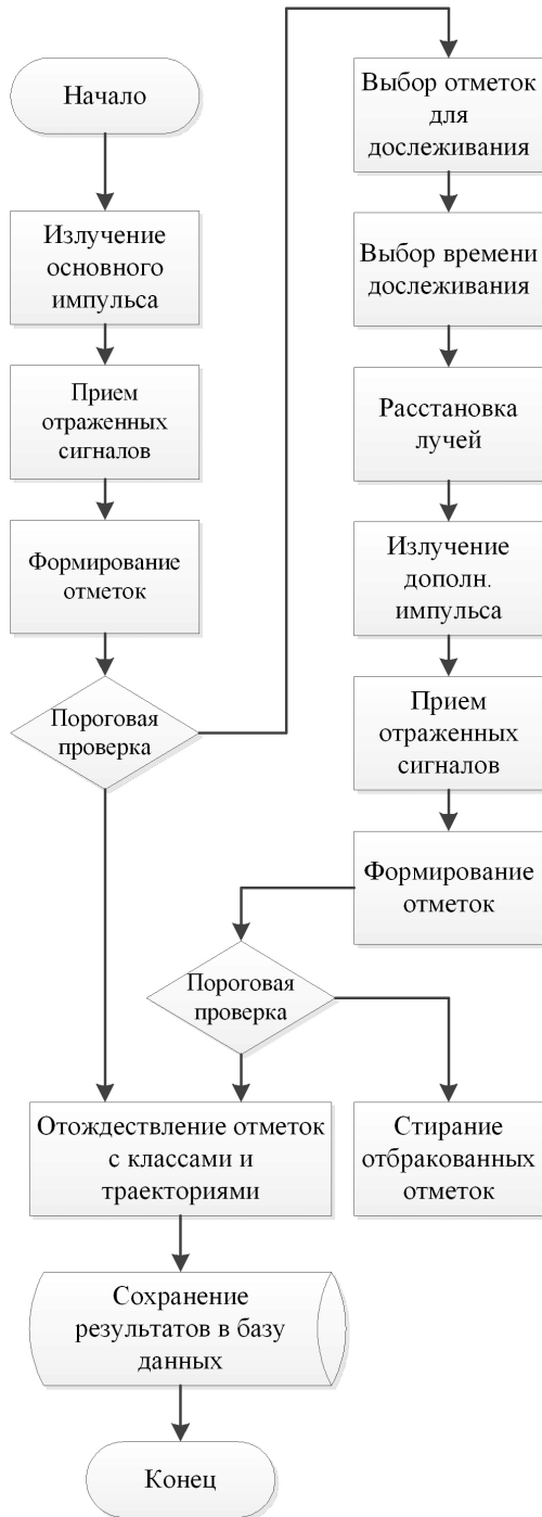
Рис. 2. Алгоритм управления АР, совмещающий жесткую программу смешанного обзора с гибкой программой обзора для отобранных целей
