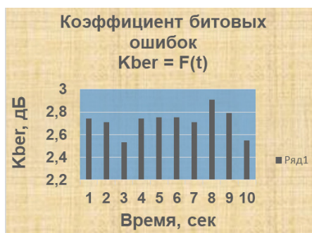
Рис. 3. Временная зависимость показателя качества при запасе устойчивости менее одного дБ Fig. 3. Time dependence of the quality index with a stability margin of less than one dB
