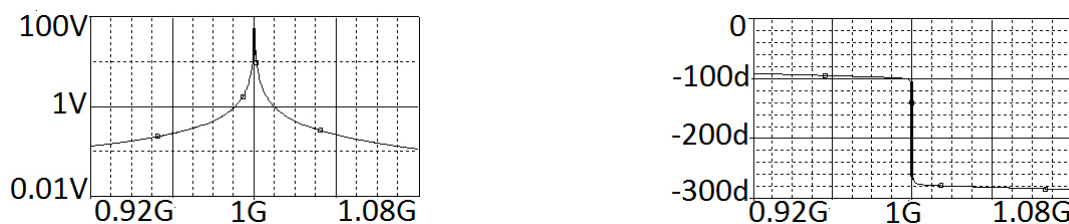
Рис. 12. АЧХ (а) и ФЧХ (б) эквивалентной схемы усилителя (рис. 11), полученные в системе OrCad (б)
