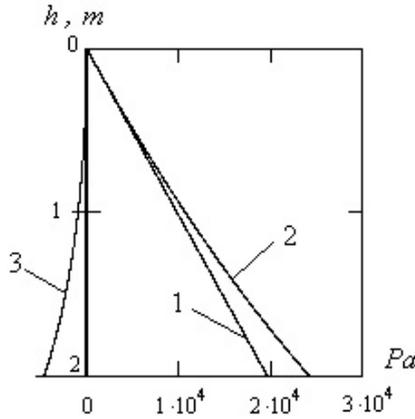
Рис. 3. Распределение давлений по высоте вертикального резервуара с упругими стенками: прямая 1 – гидростатическое давление  $P_{z/c}$ ; 2 – давление  $P = P_{z/c} + P_c$ ; 3 – объемная плотность энергии растянутой упругой стенки резервуара –  $P_c$
