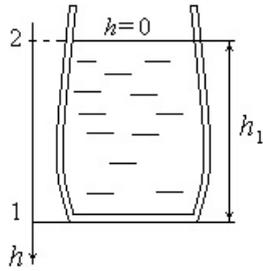
Рис. 1. Изменение формы упругого резервуара
