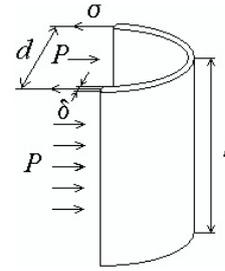
Рис. 2. Участок оболочки вертикального упругого резервуара
