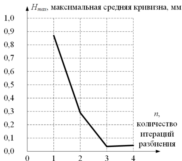
Рис. 8. График расчета максимальной средней кривизны для поверхности, полученной из каркаса SOD Fig. 8. Graph of the calculation of the maximum average curvature for the surface obtained from the SOD wireframe
