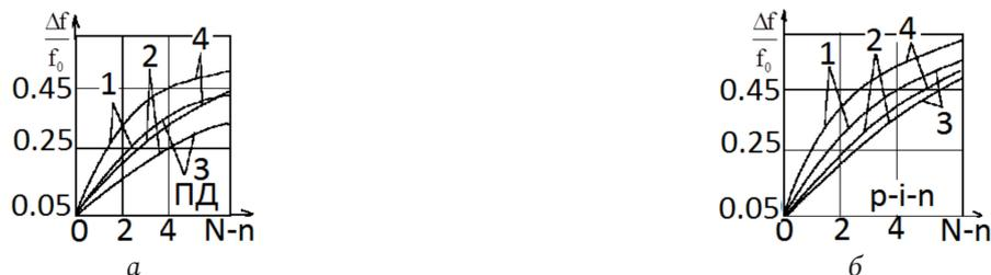
Рис. 13. Зависимость широкополосности СНС с одним пассивным управляемым слоем на основе параметрических диодов ПД и p-i-n-диодов, содержащих со стороны свободного пространства два диэлектрических слоя (1) и один диэлектрический слой и неуправляемую решетку (2), от количества оптимизируемых параметров при ограничениях  $(0,5 \leq m \leq 1,0; 160^\circ \leq \Delta\varphi \leq 200^\circ)$  (3) и  $(0,5 \leq m \leq 1,0; 80^\circ \leq \Delta\varphi \leq 100^\circ)$  (4)
