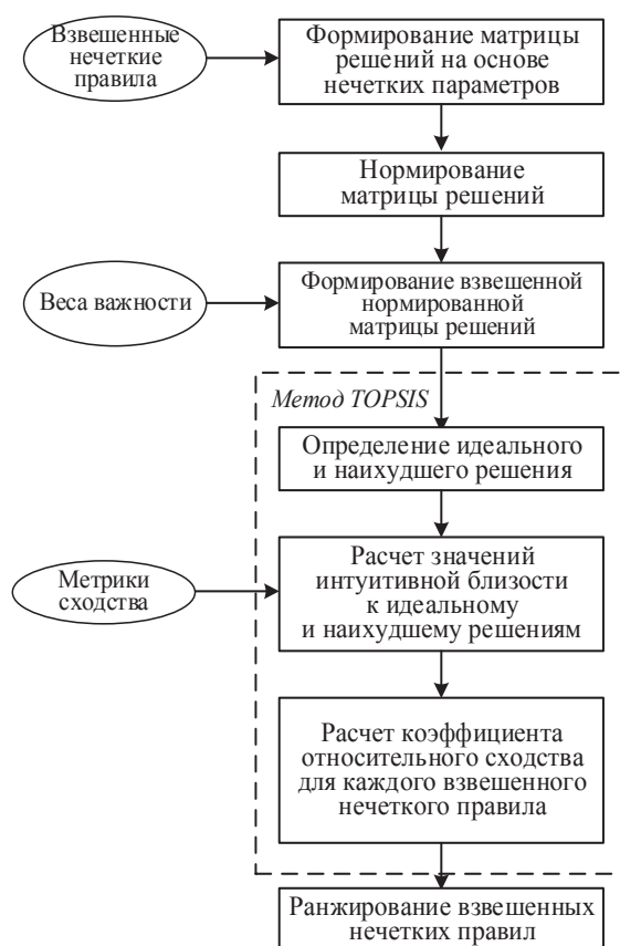
Рисунок 4 – Этапы оценивания технического состояния электрооборудования
