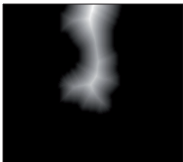
Рисунок 13 - Пример нормализованного Евклидова преобразования расстояния
