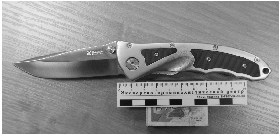
Фото № 1. Детальная фотосъемка ножа, на рукоятке которого выявлен след папиллярного узора. Параметры фотосъемки: цифровой фотоаппарат Olympus FE-250, режим фотосъемки макро, выдержка 1/60 с, диафрагма 2. Масштабная линейка расположена в одной плоскости с поверхностью рукоятки ножа
