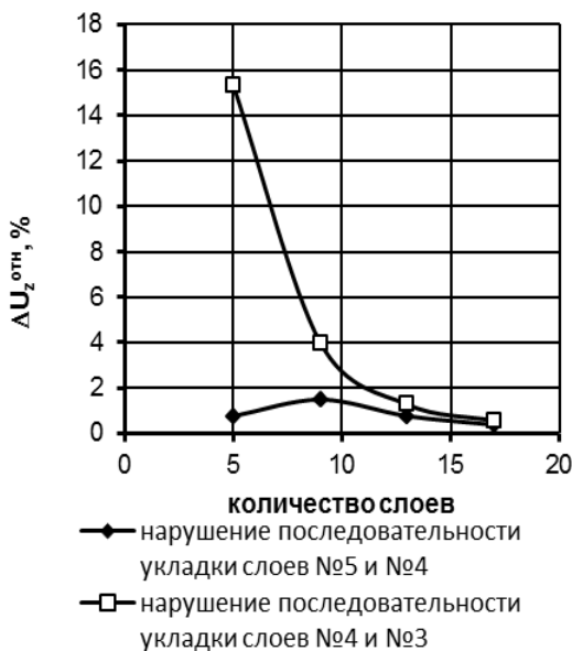
Рис. 12. Зависимость относительного изменения прогиба (по отношению к сбалансированному состоянию) защемлённой пластины от числа слоёв и варианта нарушения последовательности укладки
