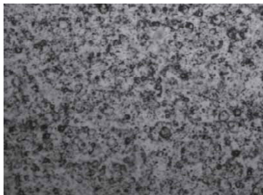
Рис.3. Топография поверхности хромовых покрытий, \times 400 : а – с микротвёрдостью 14000-14500 МПа; б – с микротвёрдостью 11000-11500 МПа
