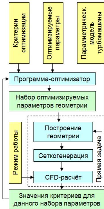
Рис. 1. Блок-схема алгоритма оптимизации решением прямых задач
