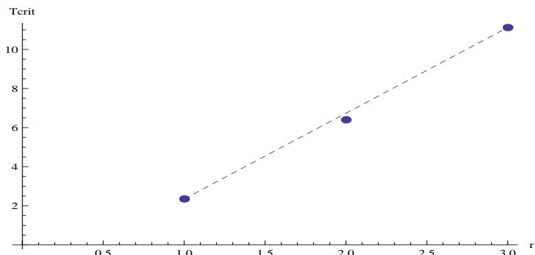
Рис. 2. Зависимость критической температуры от радиуса корреляции при нулевом магнитном поле
