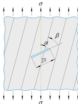
Рис. 1.1. Пластина с трещиной в анизотропном материале
