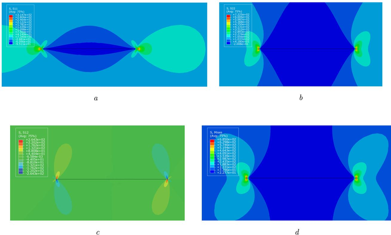
Рис. 2.1. Распределения компонент тензора напряжений и интенсивности напряжений для углов  $\alpha = 90^\circ$ ,  $\beta = 0^\circ$ :  $a - \sigma_{11}$ ,  $b - \sigma_{22}$ ,  $c - \sigma_{12}$ ,  $d -$  интенсивность касательных напряжений
