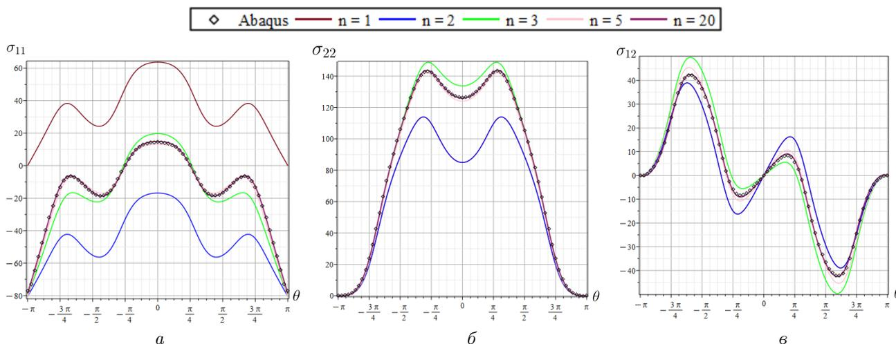
Рис. 3.6. Угловые распределения напряжений при углах  $\alpha = 90^\circ$ ,  $\beta = 0^\circ$  для пластины с размерами  $f = 10$  см,  $b = 10$  см,  $a = 1$  см:  $a - \sigma_{11}$ ,  $b - \sigma_{22}$ ,  $c - \sigma_{12}$
