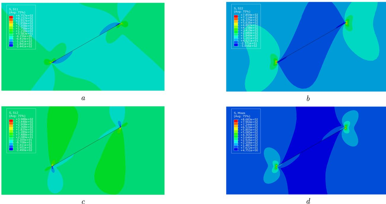
Рис. 2.2. Распределения компонент тензора напряжений и интенсивности напряжений для углов  $\alpha = 60^\circ$ ,  $\beta = 30^\circ$ :  $a - \sigma_{11}$ ,  $b - \sigma_{22}$ ,  $c - \sigma_{12}$ ,  $d -$  интенсивность касательных напряжений
