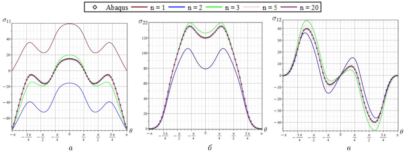
Рис. 3.2. Угловые распределения компонент тензора напряжений для углов  $\alpha = 90^\circ$ ,  $\beta = 0^\circ$ :  $a - \sigma_{11}$ ,  $b - \sigma_{22}$ ,  $c - \sigma_{12}$
