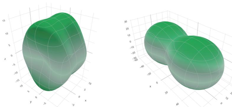
Рис. 1.2. Визуализация упругих свойств рассматриваемого материала: модуль Юнга (слева) и сжимаемость (справа)
