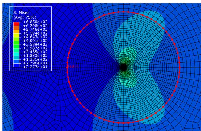
Рис. 3.1. Путь для извлечения значений компонент напряжений в окрестности вершины трещины
