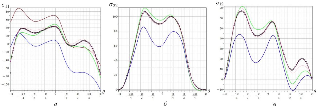
Рис. 3.3. Угловые распределения компонент тензора напряжений для углов  $\alpha = 60^\circ$ ,  $\beta = 30^\circ$ :  $a - \sigma_{11}$ ,  $b - \sigma_{22}$ ,  $c - \sigma_{12}$
