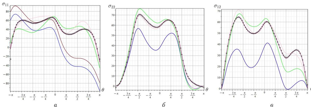
Рис. 3.5. Угловые распределения компонент тензора напряжений для углов  $\alpha = 45^\circ$ ,  $\beta = 45^\circ$ :  $a - \sigma_{11}$ ,  $b - \sigma_{22}$ ,  $c - \sigma_{12}$
