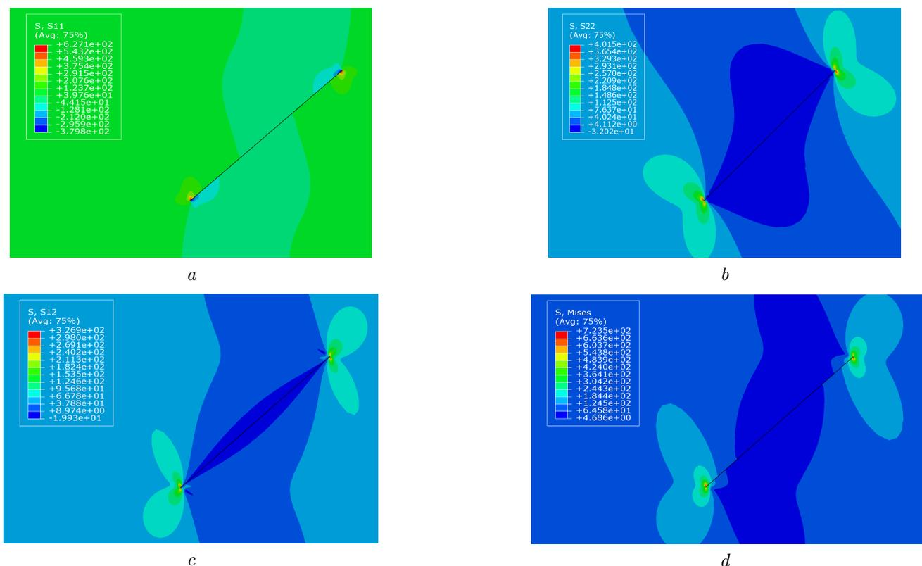
Рис. 2.3. Распределения компонент тензора напряжений и интенсивности напряжений для углов  $\alpha = 45^\circ$ ,  $\beta = 0^\circ$ :  $a - \sigma_{11}$ ,  $b - \sigma_{22}$ ,  $c - \sigma_{12}$ ,  $d -$  интенсивность касательных напряжений
