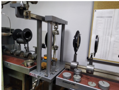
Рис. 3.1. Экспериментальная поляризационно-проекционная установка ППУ-7 Fig. 3.1. Experimental setup
