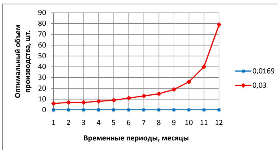
Рис. 16. Распределение оптимальных объемов производства между двумя подразделениями для экспоненциальной модели кривой обучения
