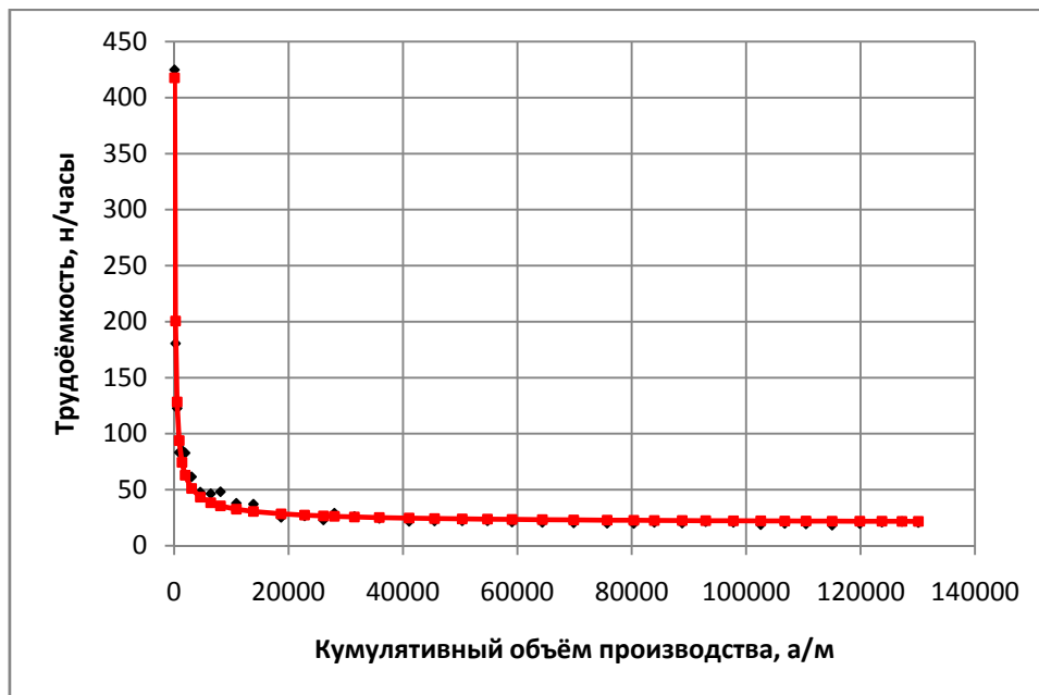
Рисунок 9 – Степенная модель Дейонга кривой обучения для автомобилей «Нива-Шевроле» Figure 9 – Deyong's power-law model of the learning curve for Niva-Chevrolet cars
