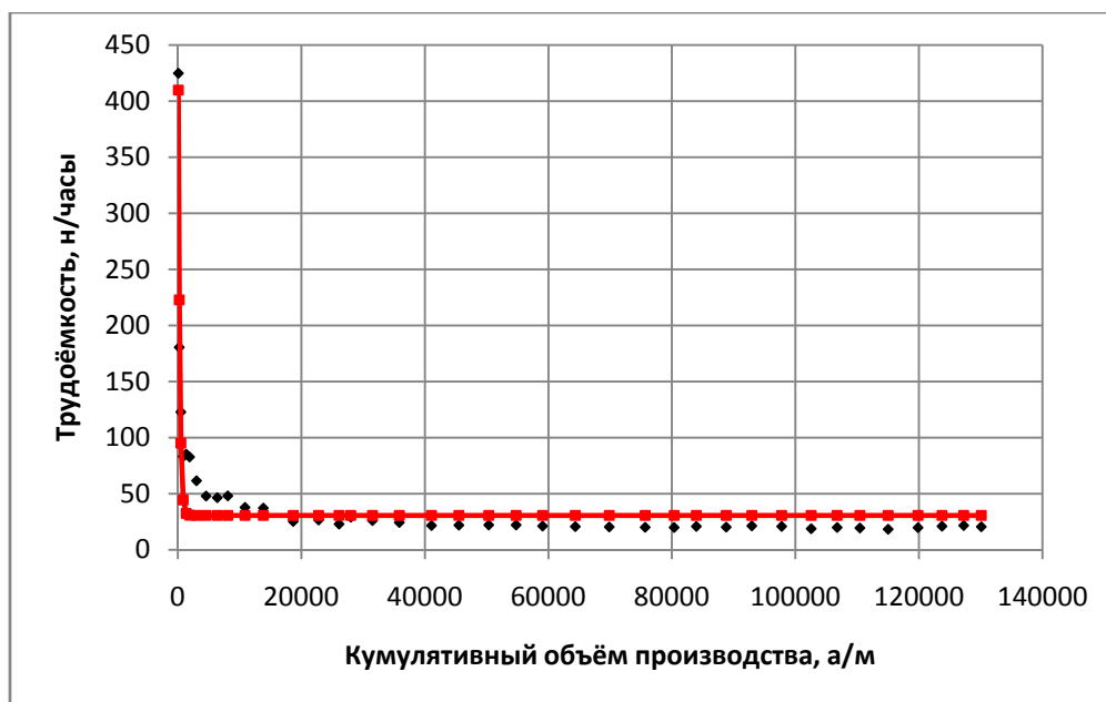
Рисунок 10 – Экспоненциальная модель кривой обучения для автомобилей «Нива-Шевроле» Figure 10 – Exponential learning curve model for Niva-Chevrolet cars
