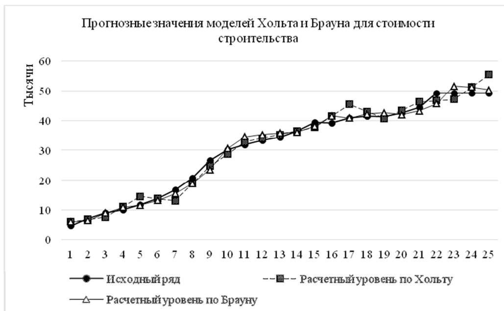
Рисунок 3 – Прогнозные значения моделей Хольта и Брауна для стоимости строительства
