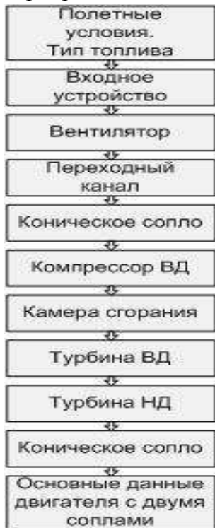
Рис. 4. Последовательность расчета базовых модулей при проектном расчете двухвального ТРДД
